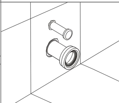
8. Направьте сливное отверстие на сливную трубу унитаза, патрубок так же должен быть направлен на впускную трубу. Установите унитаз горизонтально.
