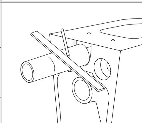
5. Действуйте как показано на рисунке. Отрежьте отмеченную часть трубы, а затем отшлифуйте поверхность напильником.
