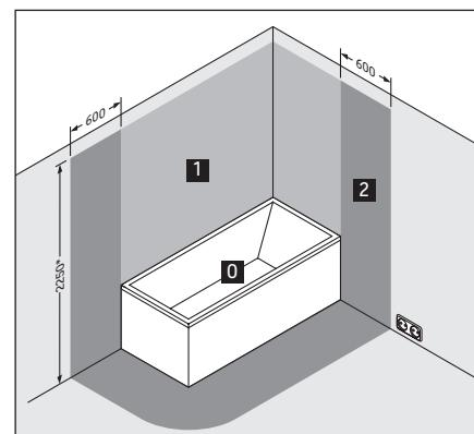
\* 或固定安装的淋浴喷头/出水口的最大高度;以最大高度为准
