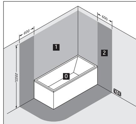
\* vai visaugstāk uzstādītā dušas sietiņa / ūdens izplūdes augstums; atkarībā no tā, kas atrodas augstāk
